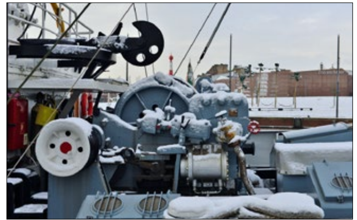
Der Winter ist vorbei – jetzt kann auch wieder die achtere Schleppwinde zum Festmachen in den Häfen benutzt werden.
